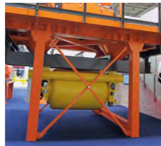
Ausgefeilte Transporttechnik – die Kübelbahn. Sophisticated Handling Technology – Flying Bucket System.
